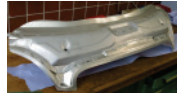
Frontklappe AlSi1Mg0,8 / t = 1,15 mm
