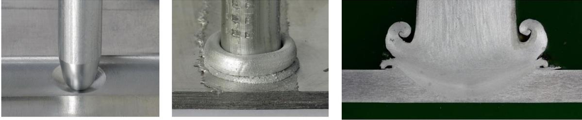
Bolzen AlMg2,7Mn,  $\varnothing 9,5$  mm an FSW-geschweißtem Blech AlMg3 F29 mit ausgebohrtem Endloch, Lochmulde R8, Lochbodendicke 0,2 mm
