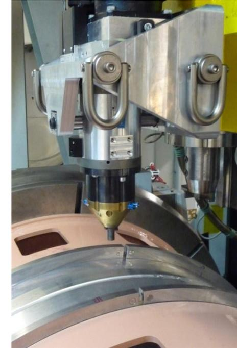
Anwendung: Reibpunkt-Lochschluss an FSW-Rundnaht, Al 2019, t = 4 mm /MT Aerospace/
