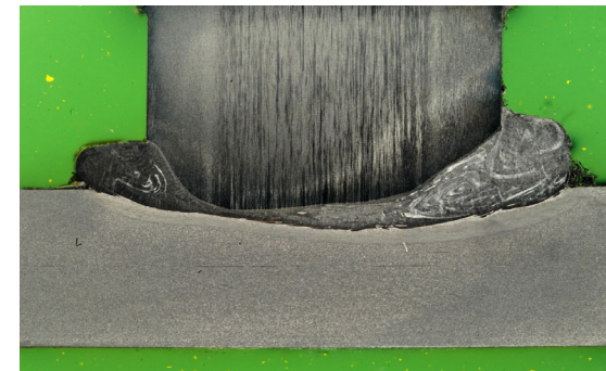
Schliff einer optimierten S-W-Bolzenschweißung, 19 mm
