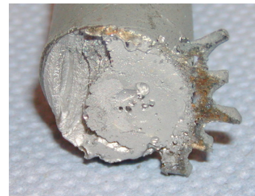
Bindefehler mit erheblicher Qualitätsminderung beim Bolzenschweißen mit Hubzündung
