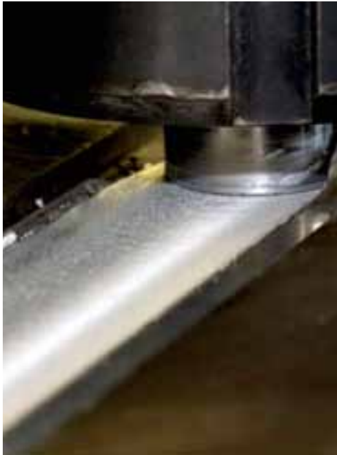
Rührreibschweißen einer Aluminium/Stahlverbindung (während des Prozesses)
