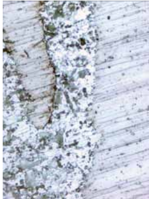
Schliffbild einer Aluminium/Stahlverbindung
