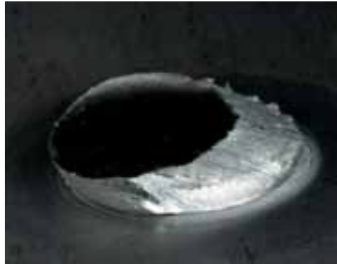
b) Detail Scherzugprobe, FS = 6,8 kN
