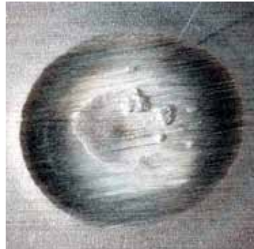
b) Punktoberfläche nach dem 35. Nach-bearbeitungsintervall
