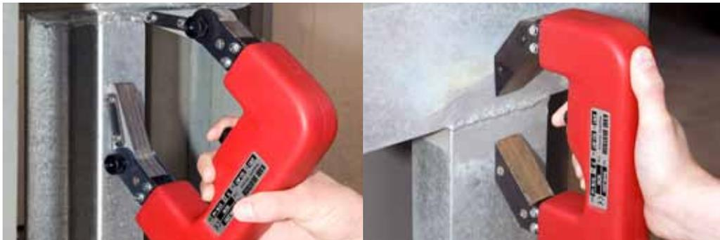
Handjochmagnete mit modifizierten Vorsatzpolen zur Prüfung feuerverzinkter Stahlbaukonstruktionen.
