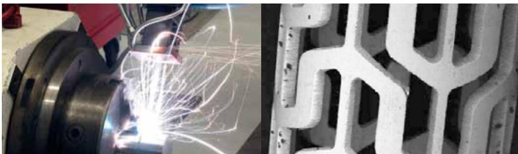
*links:* 16 kW Scheibenlaser bei Versuchen zum Schweißen von Aluminiumlegierungen größerer Dicke;
