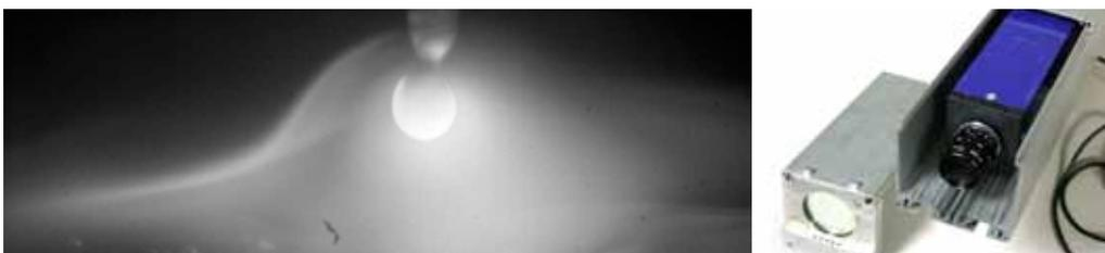
links: Tropfenbildung MSG-Impulsprozess; rechts: Kamerasystem mit Schutzeinhausung
