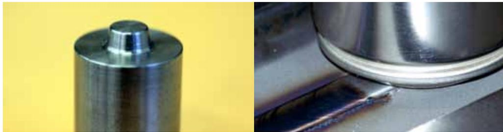
*links:* Werkzeugeinsatz aus Tantal (neu); *rechts:* Rührreibschweißen von Stahl an der SLV Berlin-Brandenburg (mit Schutzgasabdeckung im Nahtbereich)
