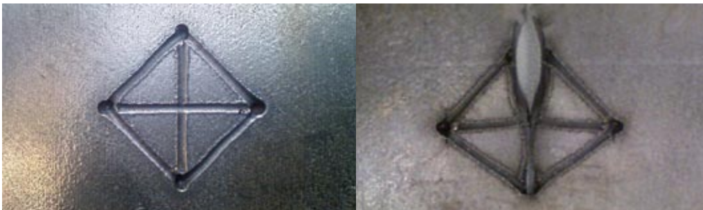
Einfluss unterschiedlicher Markiertiefen auf die Ermüdungsfestigkeit von plasmamarkierten Proben
