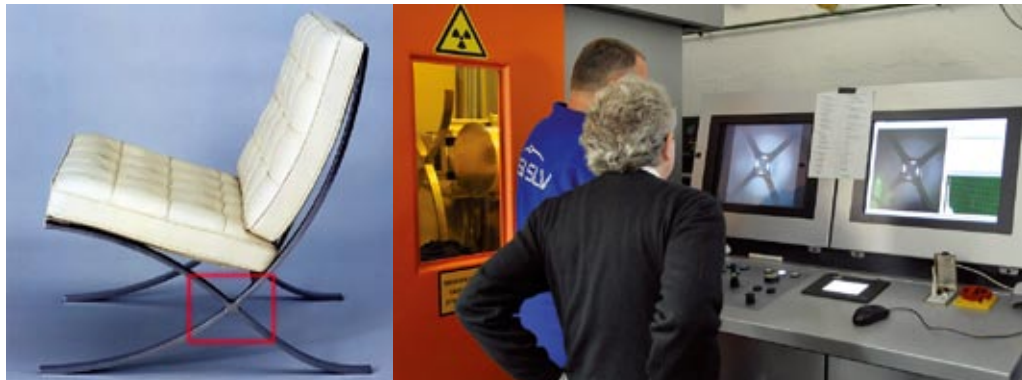
Bild links: Barcelona-Sessel von 1929. In der roten Umrahmung sind der Kreuzknoten sowie die angeschweißten Stegeisen zu sehen; Bild rechts: Die digitale Radioskopie-Vollschutzanlage in Duisburg
