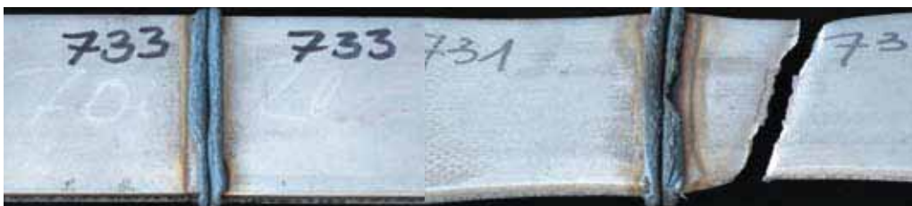
links: Orbital reibgeschweißte Flachbandverbindung 40x5 mm, X5CrNi18-10, rechts: Bild: Zugprobe einer orbital-reibgeschweißten Flachbandverbindung 40x5 mm, X5CrNi18-10 Zugfestigkeit R_m = 690 \text{ N/mm}^2 , Bruch im Grundwerkstoff
