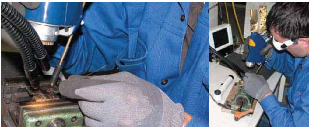
Ergonomisch verbesserter Bearbeitungskopf für das manuelle Laserreparaturschweißen mit gepulsten Lasersystemen
