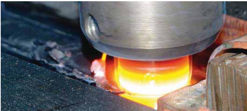
Rührreibschweißen von hochfestem Baustahl mit induktivem Vorwärmprozess
