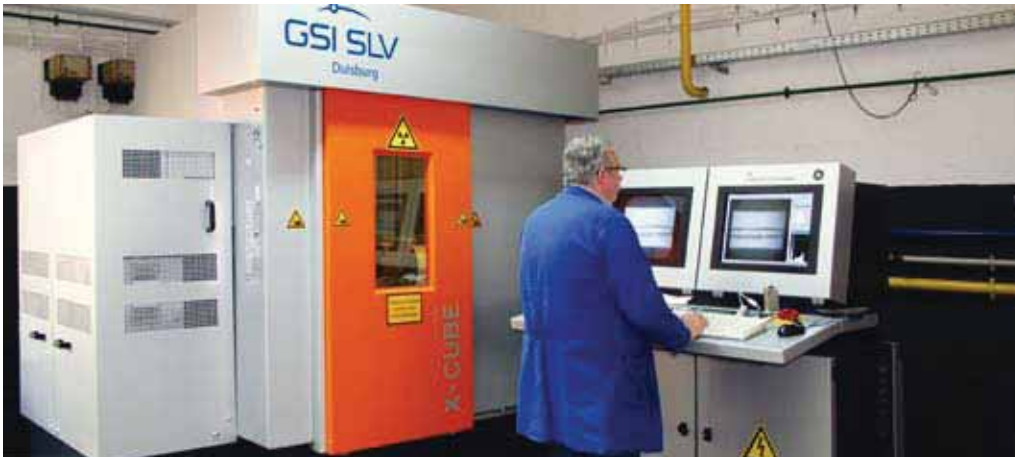
Neue Vollschutzkabine mit digitaler Aufnahme und Auswertung
