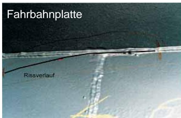
Mit Hilfe der Wirbelstromprüfung nachgewiesene Rissverläufe unter einer Korrosionsschutzschicht
