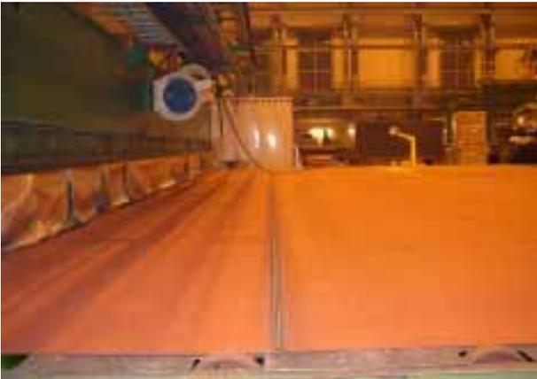
Laserhybridgeschweißtes Paneel nach dem Verlassen der Einseitenschweißstation
