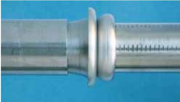
Reibgeschweißte Wellenverbindung 16MnCr5/TiAl6V4,  $\varnothing$  18 mm
