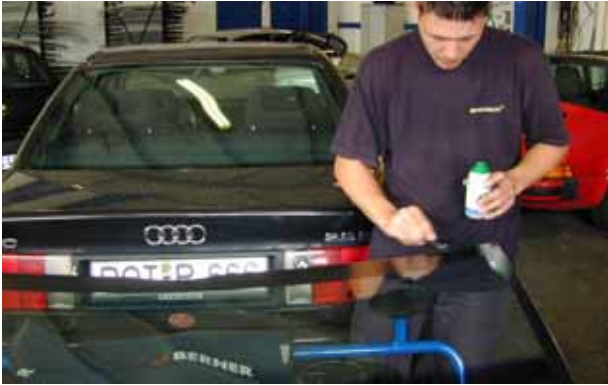
Eine geklebte Scheibe ist nur so gut wie die Vorbehandlung (Primerauftrag)
