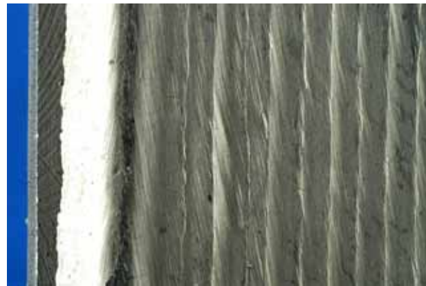
Aufgetragene Verschleißschutzschicht (Draufsicht)
