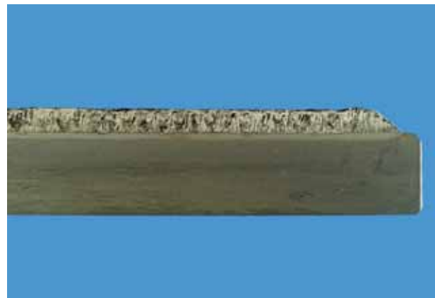
Aufgetragene Verschleißschutzschicht (Schliff)
