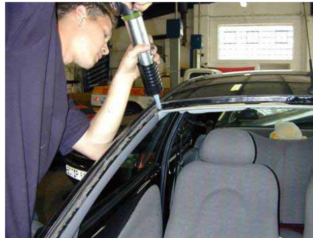
Einkleben von Frontscheiben in Kfz-Instandsetzungswerkstätten
