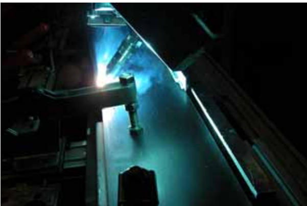
Laser-MSG-Hybridschweißen am T-Stoß (Doppel-T-Träger)
