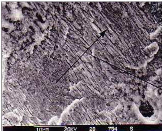
Abb. 1: Dauerbruch (Schwingbruch) in einem Tragarm eines mobilen Krans aus S355J2G3
