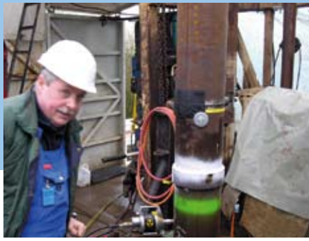
Durchstrahlungsprüfung an einer Förderrohrleitung mit IR 192
