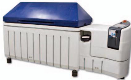
Moderne Klimakammer für Auslagerungsversuche von Grundwerkstoffen, Beschichtungssystemen und gefügten Bauteilen
