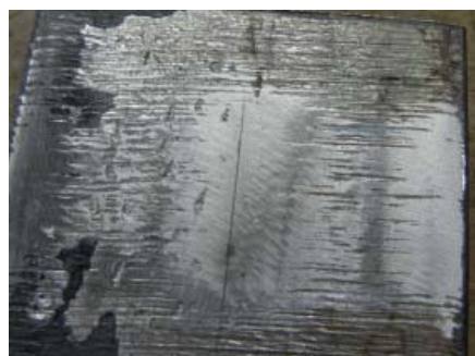
Angeschliffene Brennschnittkante an einem Stahl S460NL, Blechdicke 60 mm. Die Rillenstruktur der Schnittkante ist noch gut zu erkennen.
