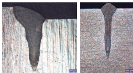
links: rissfreie Rohrflanschschweißung - stirnseitige Axialnaht, \varnothing 10 \times 1 mm, Werkstoff 1.4435 rechts: schmale und tiefe Einschweißung, Werkstoff 1.4301
